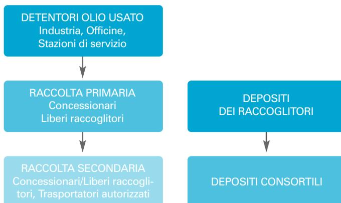
*Rete di raccolta dell'olio usato del Sistema Consorzio: il prelievo dei lubrificanti usati dai detentori (raccolta primaria) viene effettuata dalle imprese di raccolta direttamente o tramite sub-raccoglitori. Gli automezzi dei Concessionari sono contrassegnati con il marchio COOU. La raccolta secondaria è effettuata dai concessionari/liberi raccoglitori coordinati dal COOU.*
